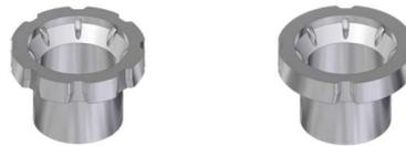
Die Fenstergriffe sind standardmäßig mit Nocken im Durchmesser von 10mm erhältlich. Bei Bedarf können die Durchmesser der Fenstergriffnocken mittels zweier Kunststoffhülsen im Durchmesser von 10mm auf 12mm erhöht werden.
