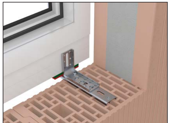
VBW-65x95x2,5 U-Profil, EL-Anker
