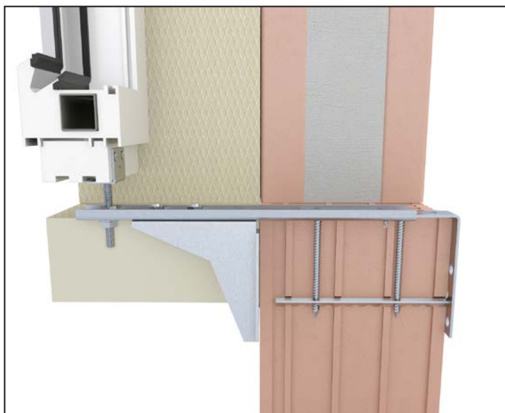
WU-ST-Anker mit Winkelanschluss
