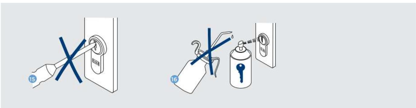
15 Keine Fremdkörper in den Schließkanal stecken.
